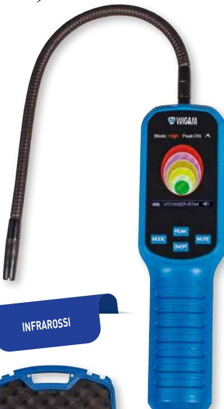
**VOYAGER (R744)****Cercafughe ad infrarossi per R744 (CO<sub>2</sub>)**VOYAGER- R744 è dotato di un sensore ad infrarossi specifico per R744(CO<sub>2</sub>) che offre superiore precisione, insensibilità ai falsi allarmi e una vita utile prolungata.
